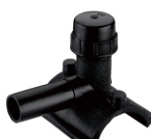
10 EF Tapping Tee PE 100 Black PN 10, PN 16 Size 63x20 - 315x110
