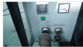
Sambungkan kabel dan plat pemanas
