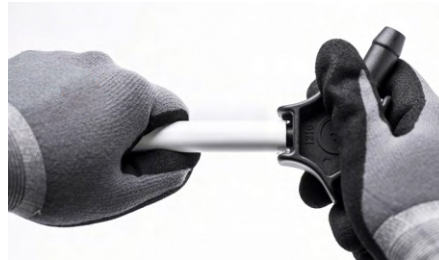
2. Beveling dan kalibrasi pipa
