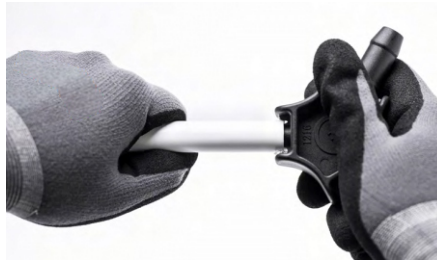
2. Pembulatan dan pemotongan miring
